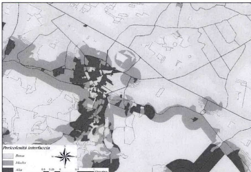
Figura 5.9 - Esempio di classi di pericolosità all'interno della fascia perimetrale (Fonte Manuale Operativo per la predisposizione di un piano Comunale e Intercomunale di Protezione Civile)
